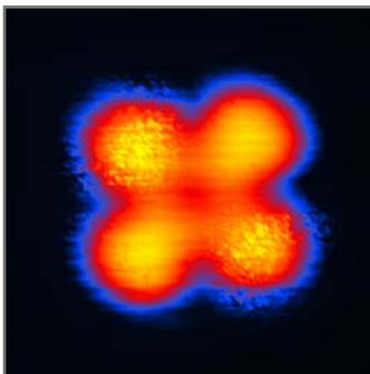
Diese Aufnahme eines Kupferphthalocyanin-Moleküls entstand mittels Rastertunnelmikroskopie. © CENIDE
