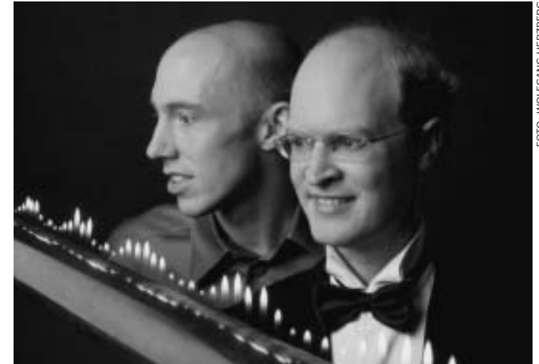
Marcus Weber (l.) und Stefan Heusler von den Dortmunder Physikanten beim Flammenrohr-Experiment: Stehende Wellen im Rohr erzeugen Flammenberge.
