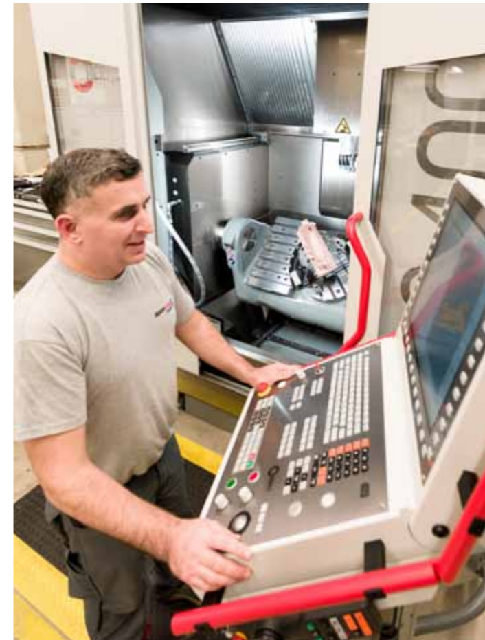
Der Bereich Strömungsmaschinen hat ein Bauteil mit Fenster bestellt. Bevor Miftar Musliu es an der 5-Achs-Fräse in Aluminium fertigt, wurde es in Kunststoff ausprobiert.
