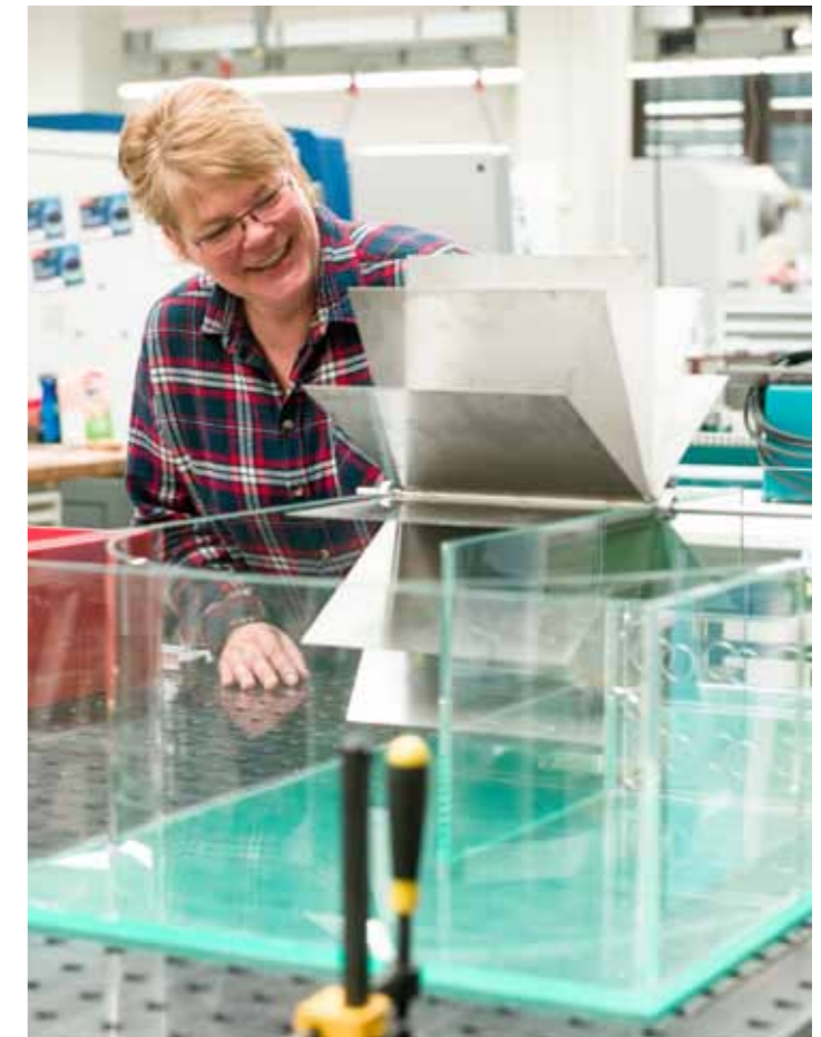
Karin Hensel ist die Expertin für Kunststoffe: Sie hat aus der Aquatischen Ökologie Skizzen für den Prototyp einer Fließrinne bekommen. Alle Teile hat sie gebogen, gefräst und zusammengebaut. Jetzt ist das Modell fast fertig.
