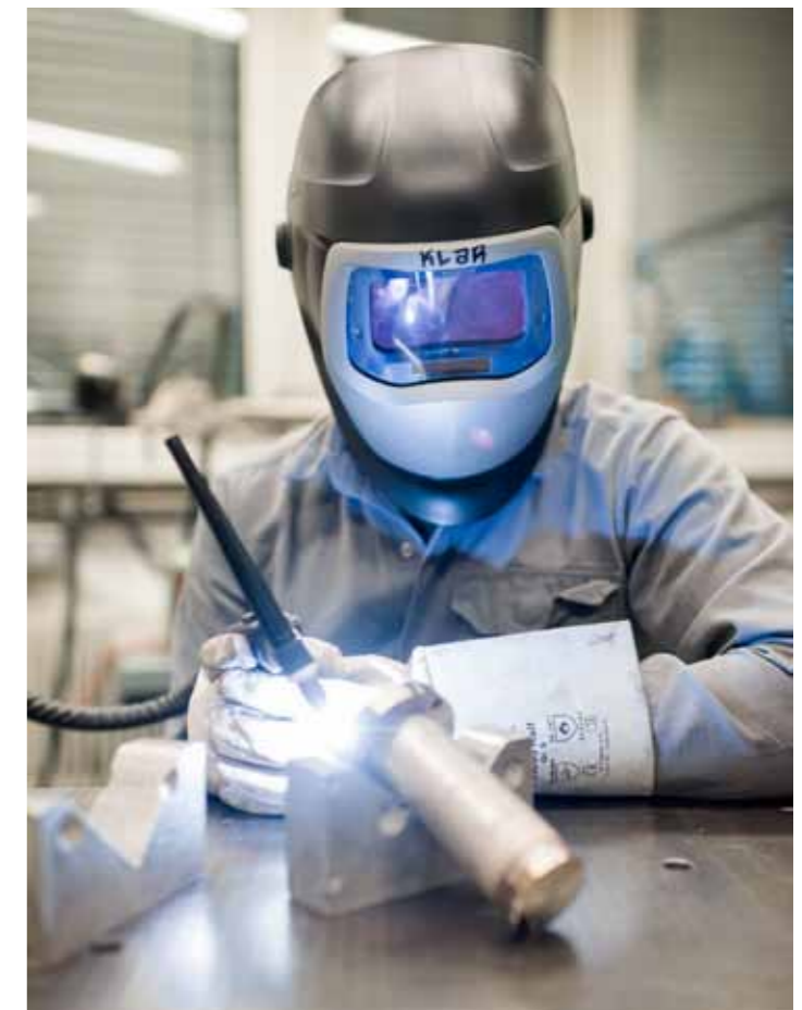
Michael Klar braucht ein ruhiges Händchen. Beim so genannten Wolfram-Inertgas (WIG)-Schweißen bekommt man besonders hochwertige Nähte hin, etwa um Hochvakuumkammern zu fertigen.
