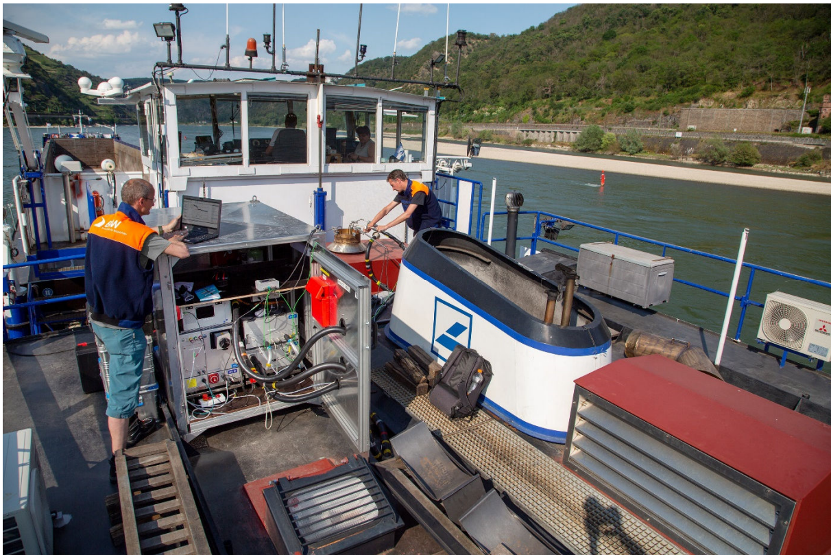
On-Board-Emissionsmessungen der Bundesanstalt für Wasserbau (Quelle: BAW)
