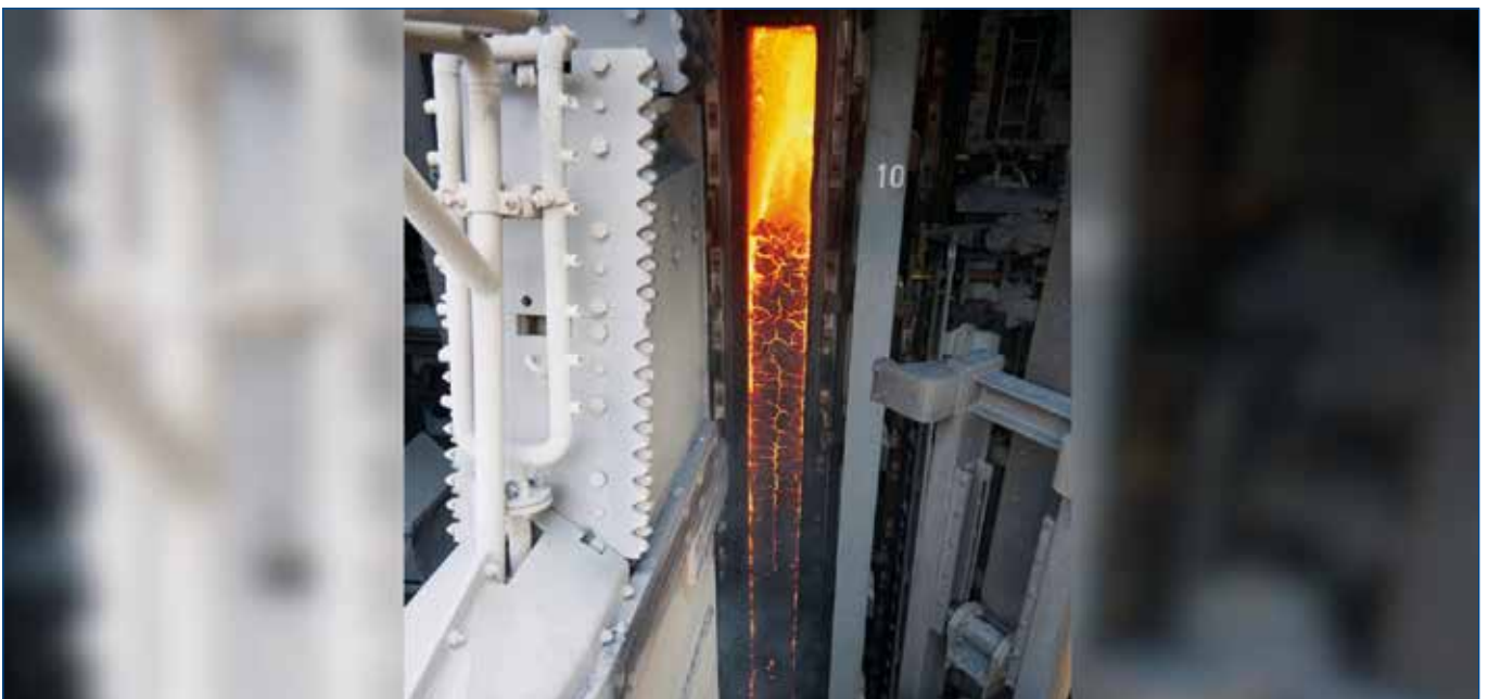
Koksofen im integrierten Hüttenwerk der thyssenkrupp Steel Europe AG in Duisburg-Bruckhausen: Hier werden flüchtige Kohlenwasserstoffe aus der Kohle entfernt, um Kohlenstoff für den Einsatz im Hochofen zu gewinnen
