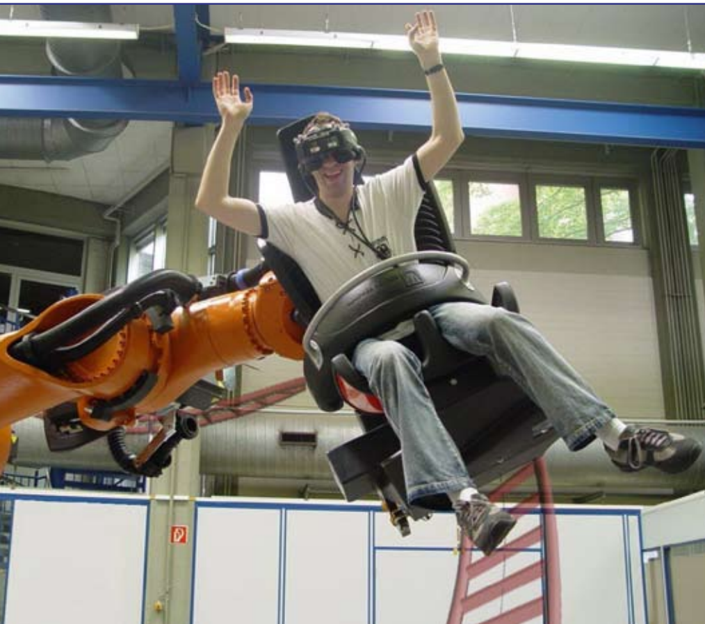
Beschleunigt wie ein Jumbo: Der neue Bewegungssimulator am Lehrstuhl für Mechanik und Robotik
