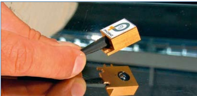
In Duisburg entwickelter 300-GHz-Transmitter mit optischer Faseranbindung und quasi-optischer Fokussierung der generierten Terahertz-Strahlung.
