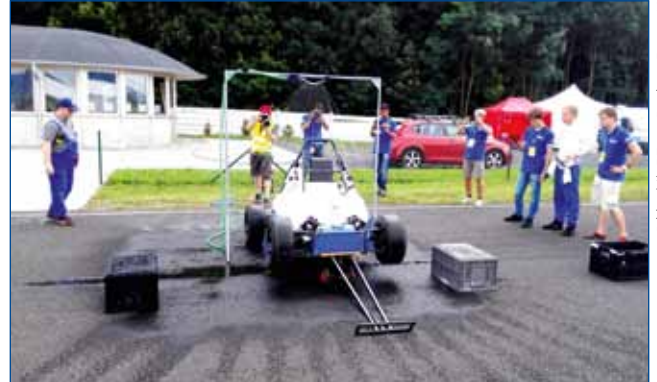
Noch ganz dicht? Der Elektrobolid beim – erfolgreichen – Rain-Test.
