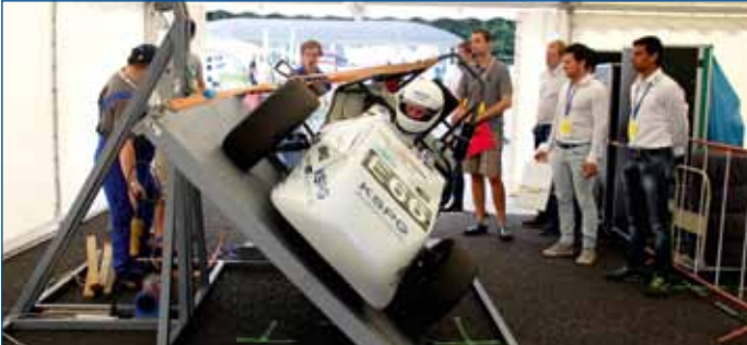
Schräge Kiste: Beim Tilt-Test werden die Wagen erst auf 45, dann auf 60 Grad gekippt. Keine Betriebsflüssigkeiten dürfen auslaufen, alle Räder müssen auf dem Boden bleiben.
