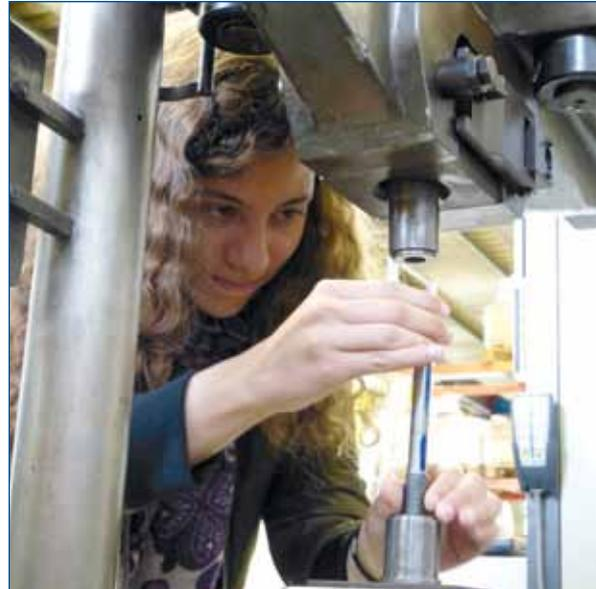
Einspannen einer Probe zur Bestimmung der Zugfestigkeit
