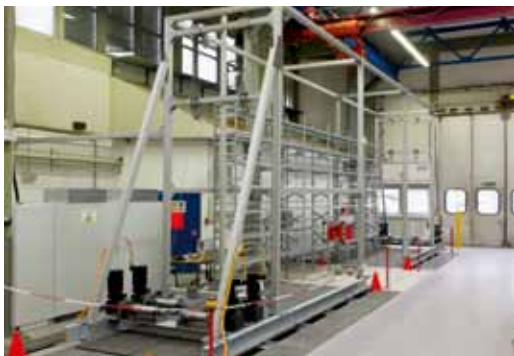
CABLAR-Roboter als seilbasiertes Regalbediengerät zum effizienten Einsatz in der Intralogistik
