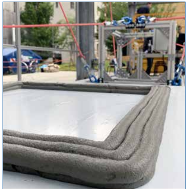
In einem neuartigen 3D-Druckprozess verarbeitet ein Seilroboter zementöses Material
