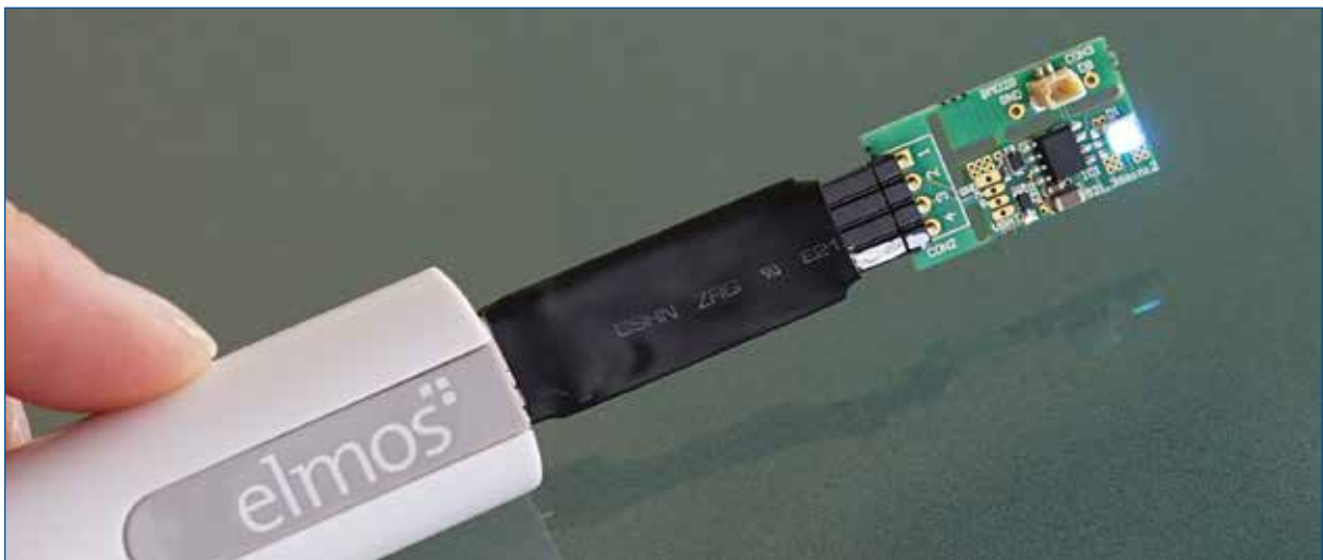
... werden gesteuert von einem LIN-RGB-Modul
