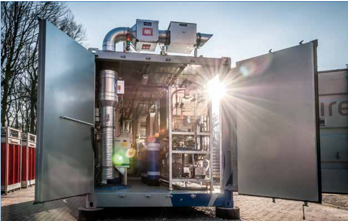
Das Wasserstoff-Testfeld umfasst verschiedene Elektrolyse-Verfahren
