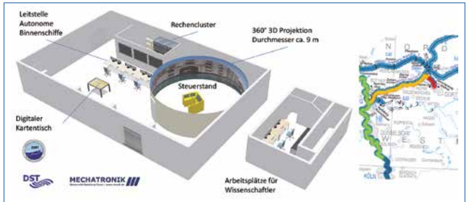
Zunächst wird ein Versuchs- und Leitungszentrum für autonome Binnenschiffe zum virtuellen Testen des autonomen Fahrens von Binnenschiffen aufgebaut
