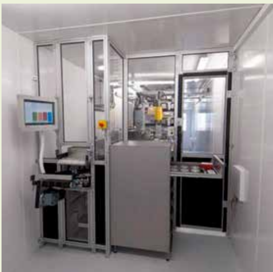
Ein mobiles, vollautomatisiertes Analyselabor – eine Entwicklung mit dem niederländischen Partner Promicol
