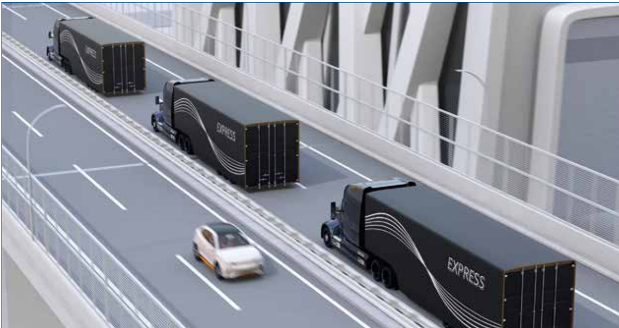
Platooning: Der erste Lkw wird gefahren, die anderen werden von ihm gesteuert und folgen ihm automatisch
