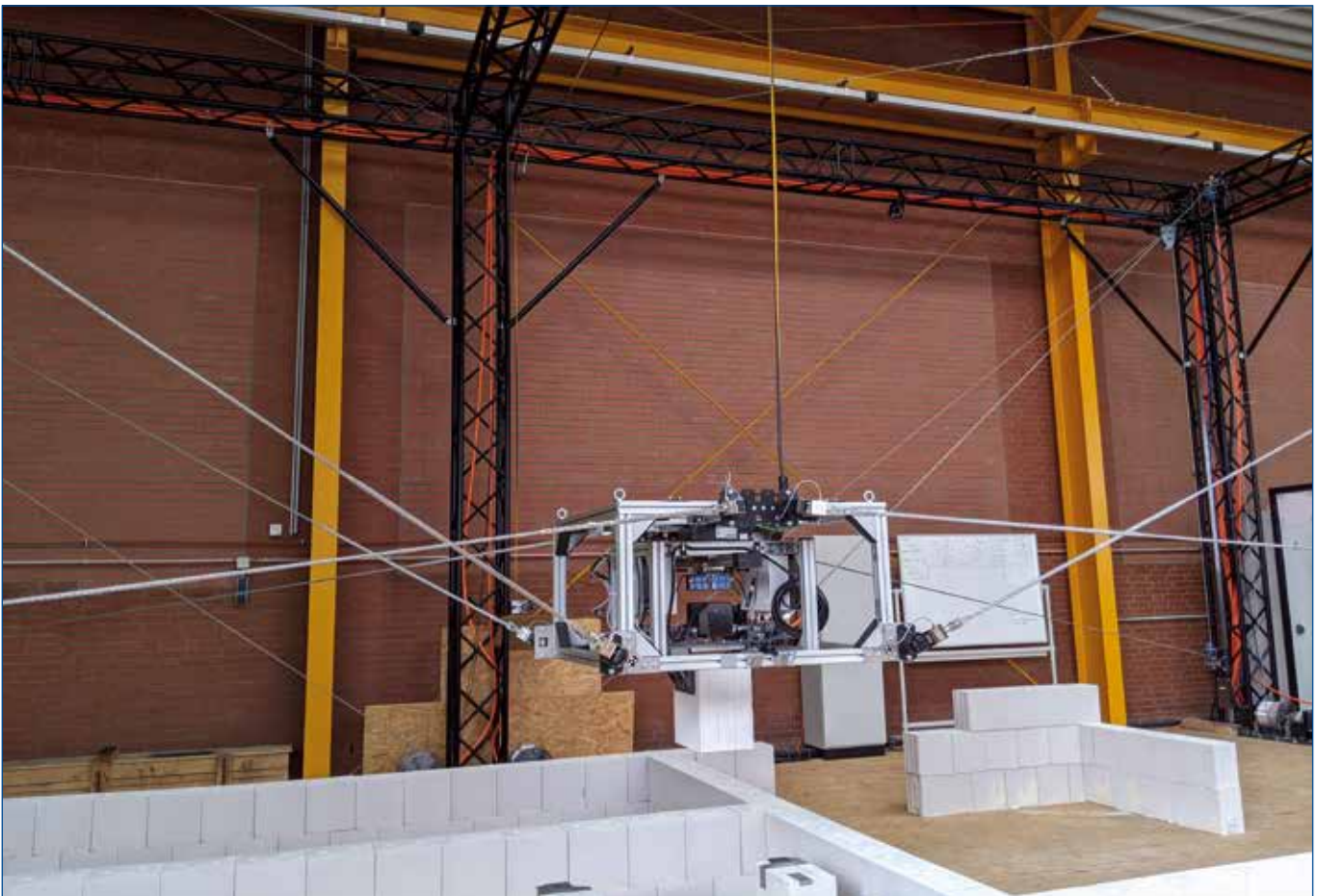
Maurer an der Leine: der Seilroboter bei der Arbeit
